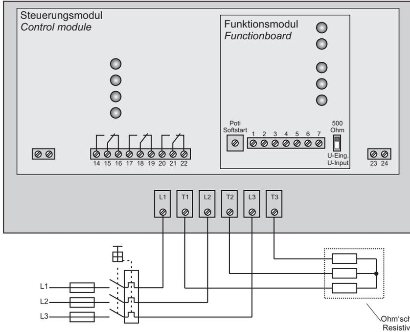
**Achtung:** Beim Typ TS2 SP 3ph ist T3 intern direkt mit L3 verbunden. Daher liegt an T3 immer Spannung an, sobald die Versorgungsleitungen L1, L2 und L3 an Spannung angeschlossen werden.
